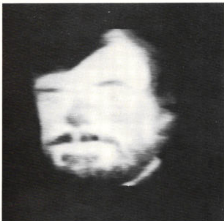
Afb. 2. De goede prestaties van de door RCA ontwikkelde experimentele 64 \times 128 elements infraroodgevoelige ladingsgekoppelde camera, blijken wel uit de kwaliteit van dit op een TV-monitor weergegeven warmtebeeld.
