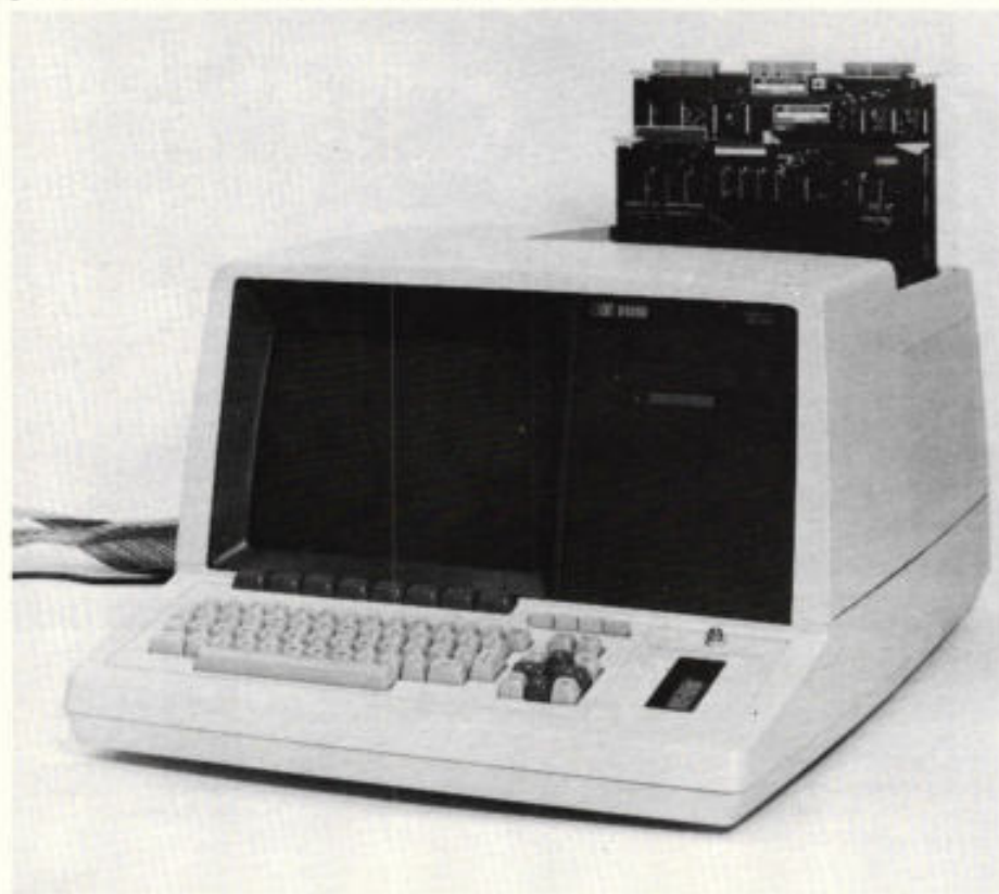
Fig. 8. De uitbreidingsruimte en zijn afzonderlijke busstructuur maakt het mogelijk om bijvoorbeeld een zeer snel (200 ns) emulatiegeheugen onafhankelijk van het gastheergeheugen aan te sluiten of emulatoren, analyzers, PROM-programmers, enzovoort.
